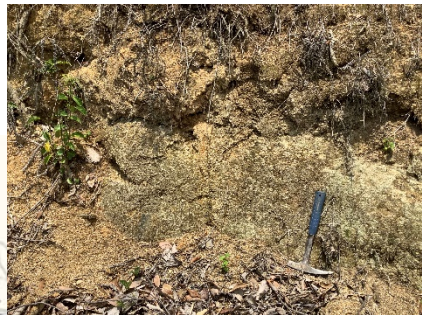
花崗岩露頭/風化作用により軟質化
