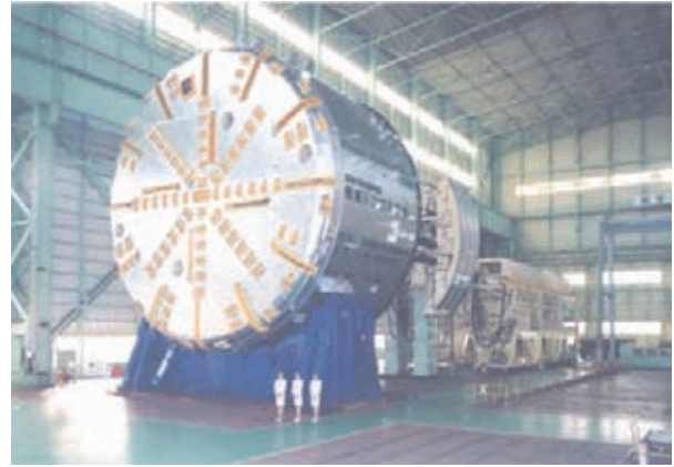
写真-1 本坑用TBM「夢天生2000」
