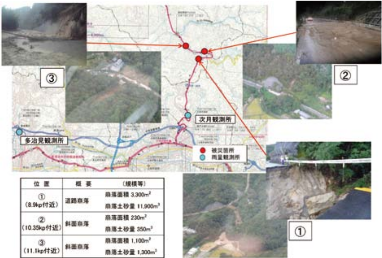
図-2.3 被災箇所の概要 (国土交通省中部地方整備局多治見砂防国道事務所提供)
