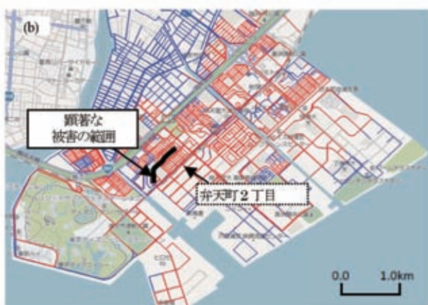
図-3 2011年東北地方太平洋沖地震による (a)東京湾沿岸地区、および(b)浦安市の噴砂の発生状況 (赤:噴砂確認箇所、青:噴砂が確認されなかった箇所) 6)
