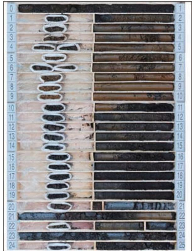
写真-10.4 ボーリングNo.1孔のコア(深度0~25m)<sup>7)</sup>
