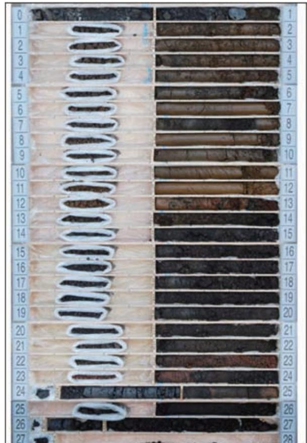
写真-10.5 ボーリングNo.2孔のコア(深度0~28m)<sup>7)</sup>
