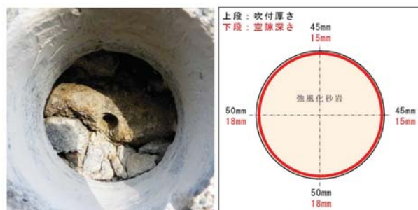
図-6 コア抜きによる観察結果
