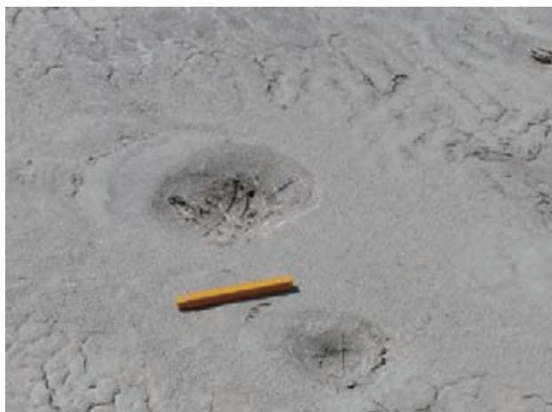
図-10 浸水域に見られる表面が侵食された噴砂跡
