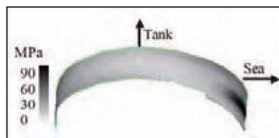
図-20 鋼矢板リング(シェル要素で評価)の曲げ変形による応力の分布(地震終了時)
