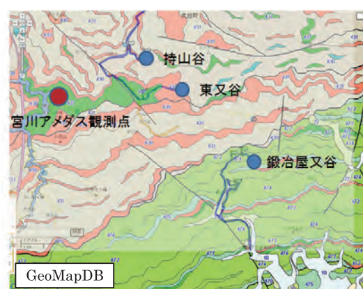
図-36 大規模崩壊地点と地質および宮川アメダス観測点 4)
