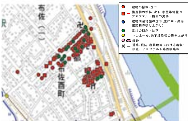
図-3.4.1 2011年東北地方太平洋沖地震による液状化発生地点の分布(千葉県我孫子市) 13)
