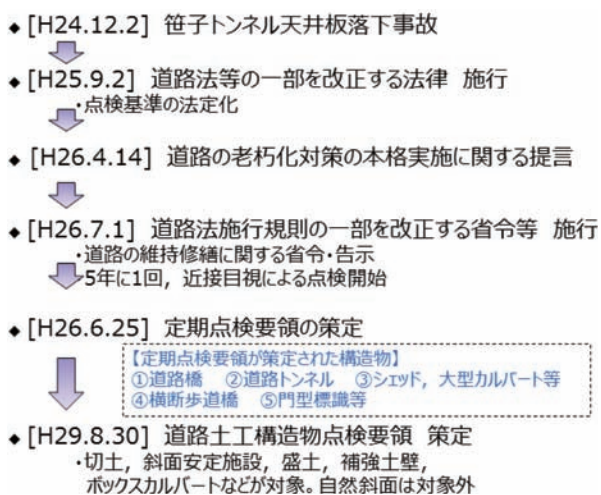
図-2.1 道路の老朽化に関する国交省の取組み
