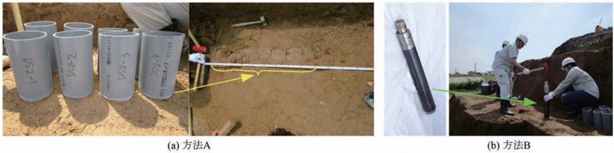
写真-3 3堤体地盤採用に開発した簡易サンプリング法
