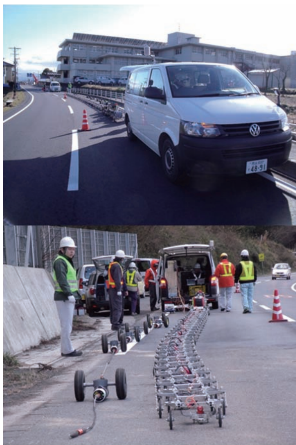
図2.10 FWD試験との同時計測
