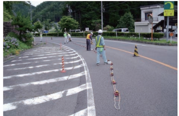
図-2.1 ランドストリーマーによる計測状況
