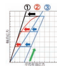
図-15 吸水軟化試験の3パターン
