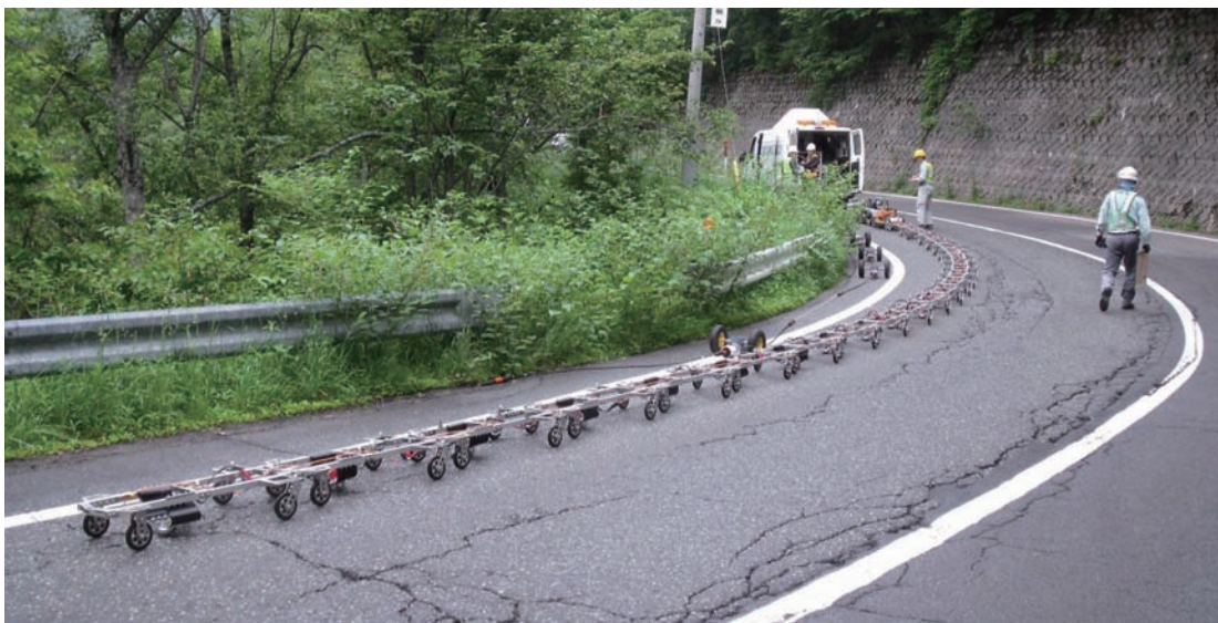
図-2.3 測定台車による牽引状況
