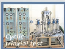
土の繰返し非排水三軸試験
