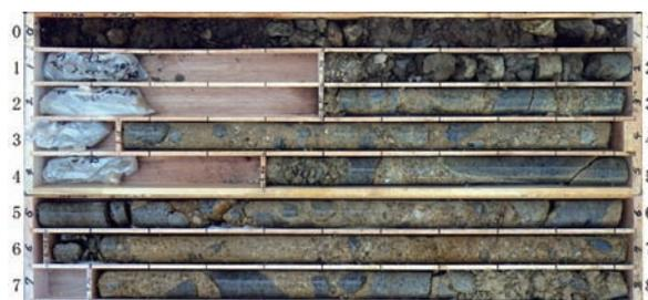
写真-3.2 コア写真の一般的な例(玉石混じり砂礫)
