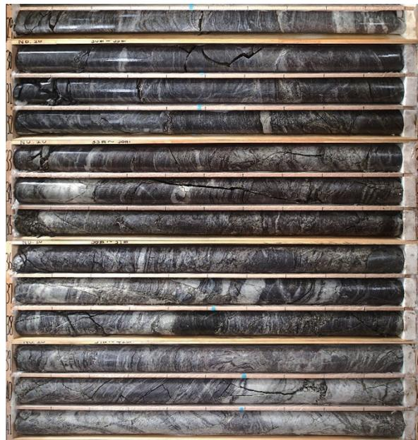
写真-3.2 経験豊富な機長が採取した破碎帯のコア
