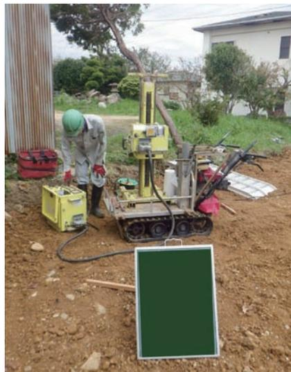
写真-4.1 スウェーデン式サウンディング試験
