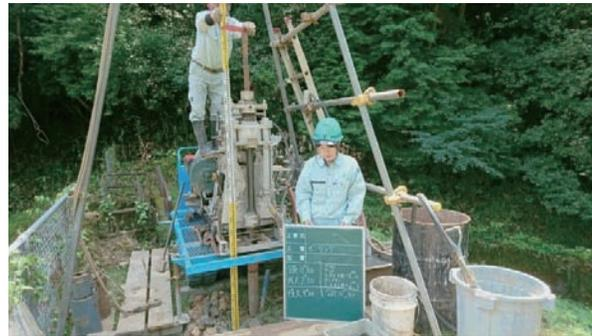
写真-2.1 ボーリング調査検尺の様子
