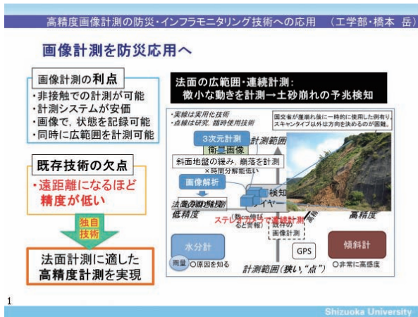
図-13 高精度画像計測の防災・インフラモニタリングへの応用
