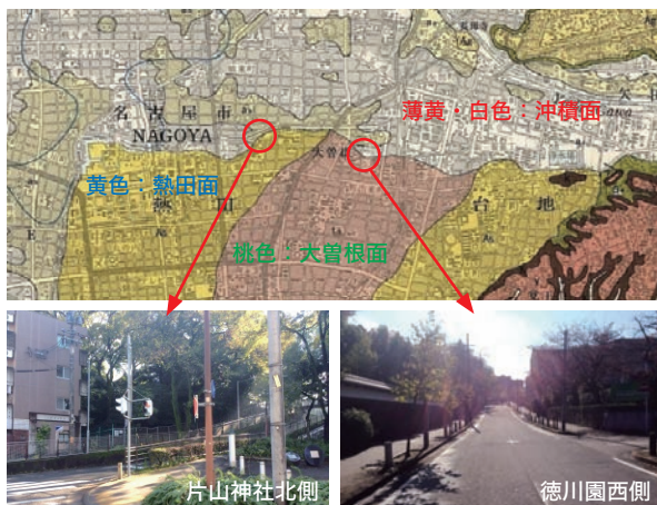
図-2 熱田面、大曽根面北端部付近の地質図 (出典：名古屋北部の地質図)
