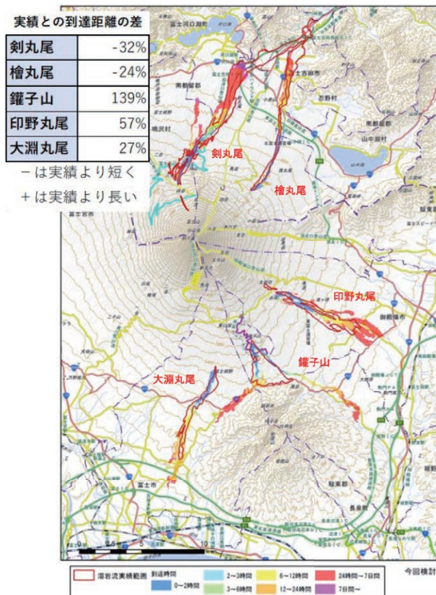
図-4.4.1 溶岩流の数値シミュレーション結果と過去の溶岩流の到達範囲の比較 6)
