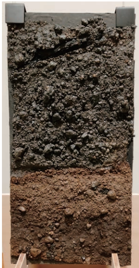
写真-4.1.3.5 風祭川火砕流堆積物の地層剥ぎ取り資料 (上部に炭化木片が含まれる)
