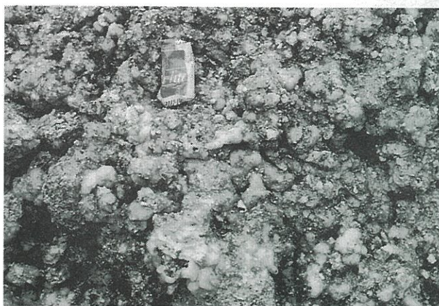
口絵写真-4 降雨後、凝灰岩から析出した糊状のモンモリロナイト
