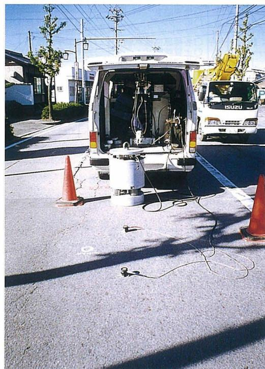
写真-1 表面波探査法の測定状況
