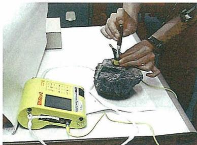
写真-1 簡易反発硬度測定状況 (不定形試料)
